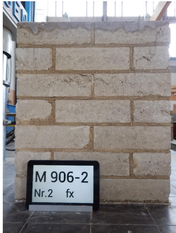
Abb.2: Bruchbild der Mauerwerksprüfung Prüfkörper 2
