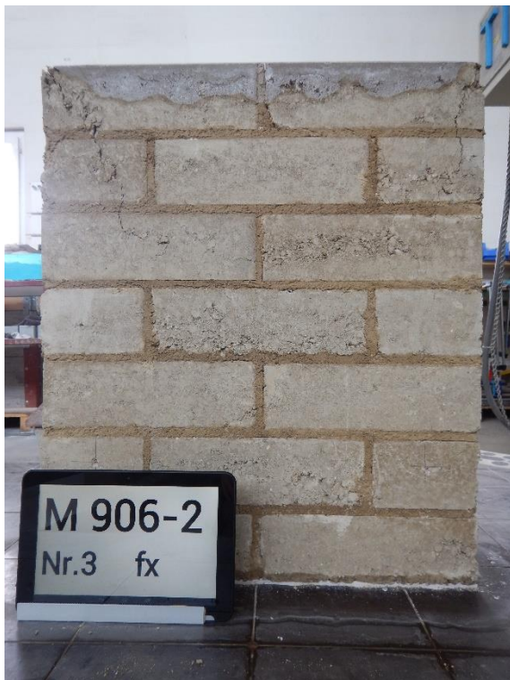
Abb.2: Bruchbild der Mauerwerksprüfung Prüfkörper 3
