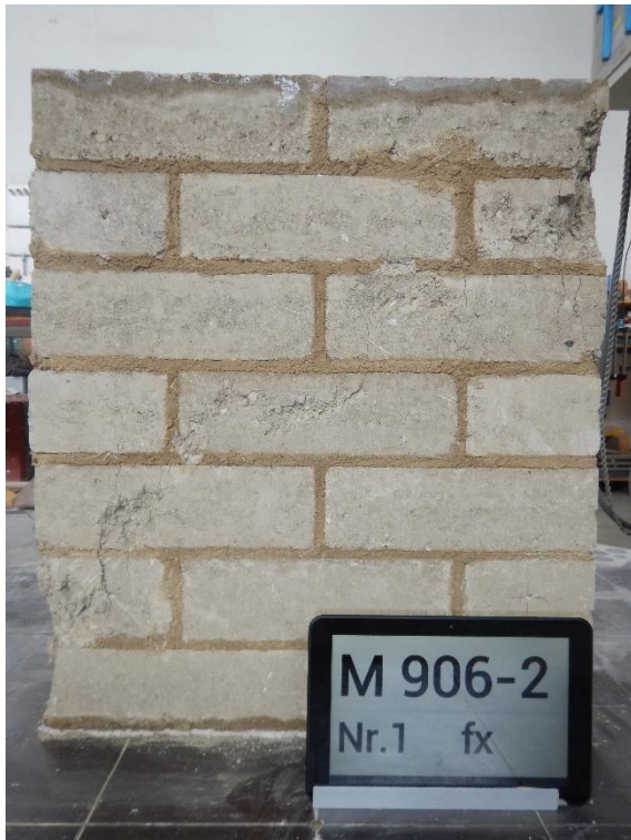
Abb.1: Bruchbild der Mauerwerksprüfung Prüfkörper 1
