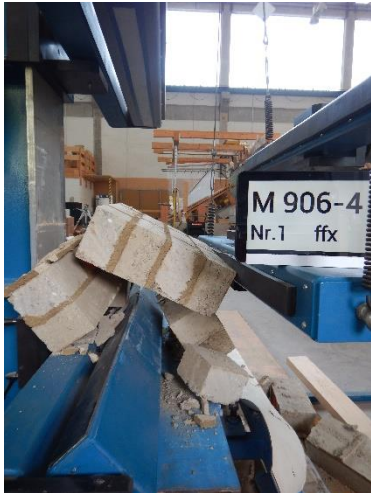
Abb.1 Bruchbild der Mauerwerksprüfung: Prüfkörper 1
