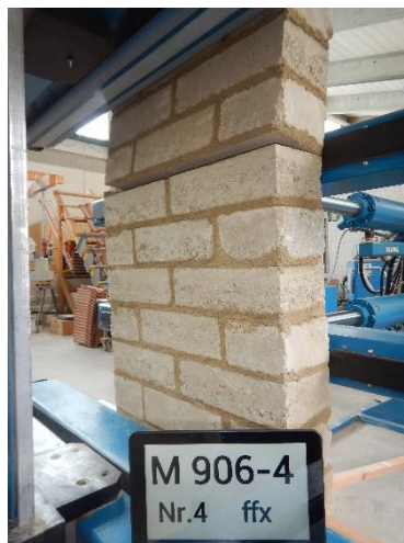
Abb.4 Bruchbild der Mauerwerksprüfung: Prüfkörper 4
