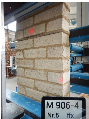
Abb.5 Bruchbild der Mauerwerksprüfung: Prüfkörper 5
