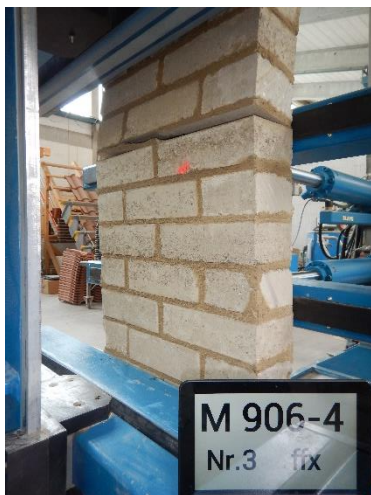
Abb.3 Bruchbild der Mauerwerksprüfung: Prüfkörper 3
