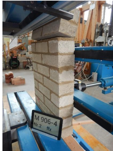
Abb.2 Bruchbild der Mauerwerksprüfung: Prüfkörper 2
